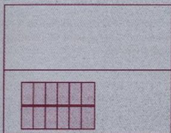
Figura 3.16: Plano de planta de una instalación fotovoltaica en una cubierta inclinada
